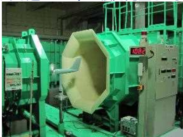
風速計に秒速108メートルの風を当てている様子
