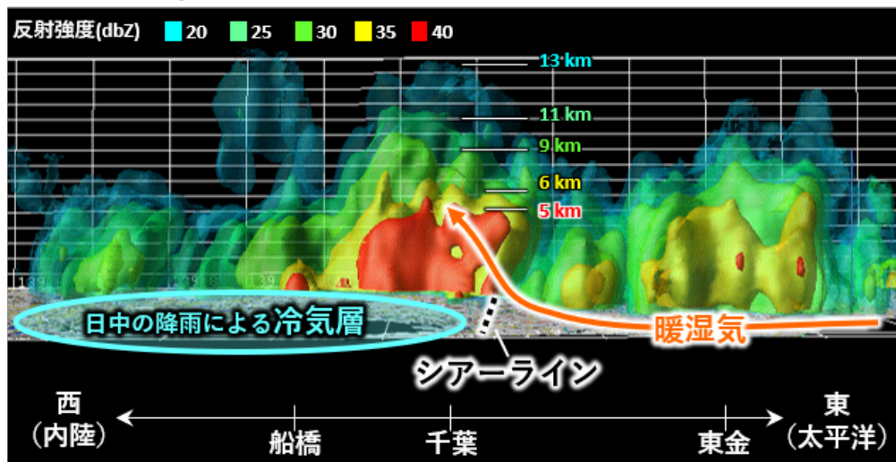
図4. 8月13日16時45分ごろに観測されたシアーラインの付近に発達する積乱雲の様子。 (上) 気象庁の東京レーダーで観測された仰角0.3度における(左)反射強度(雨の強さの指標)と(右)ドップラー速度(レーダーの視線方向の風速。正の値がレーダーから遠ざかる風の強さを表し、負の値が近づく風の強さを表す。)。 (下) 気象研究所のフェーズドアレイレーダーで観測された反射強度の鉛直構造の図。図2の右上図と同じ領域を描画したもの。東京レーダーのドップラー速度のデータから求めたシアーラインの位置(右上図の点線)が、図3の地上気象観測データから求めたシアーラインの位置と矛盾のないことが確かめられた。シアーラインの付近で、太平洋からの暖湿気が内陸側の冷氣層に乗り上げることで、積乱雲が発達している様子が分かる。
