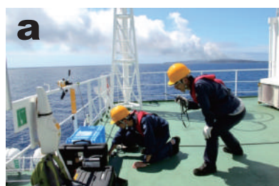
第2図: 西之島の二酸化硫黄ガス放出率観測: (a)啓風丸船上での火山ガス観測の様子(2017年5月26日)。西之島北方沖約1.5km。西之島の火口(右奥)から流れる噴煙の下を観測船で横切って測定する。(b)2014～2017年の観測結果。今回の観測値は2015年10月とほぼ同程度であった。
