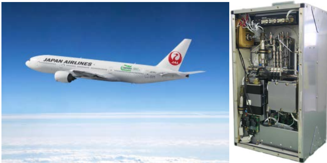
図 1. 日本航空の CONTRAIL ロゴ特別塗装機（左）と二酸化炭素連続測定装置（CME）（右）。
