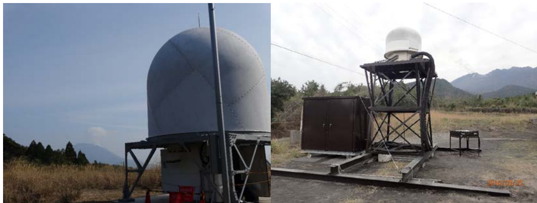
図2 (左) XバンドMPレーダーと(右)Kuバンド高速スキャンレーダー、2DVD。
