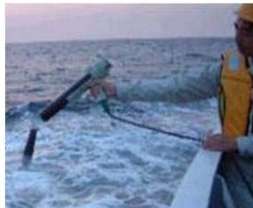
船上から XBT プローブを投下したところ。
