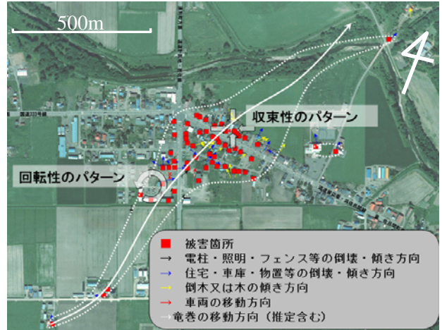
図1 竜巻による被害域(点線域)と被害箇所(赤の四角形)、被害から見積もった風向(矢印)、及び、目撃等から推定した竜巻経路(曲線の矢印)。航空写真は被害前に撮影((株)シン技術コンサル)。
