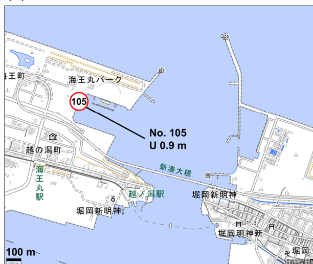
図 A11. 富山県の海王丸パーク（調査地点番号: 105）の測定点の位置及び潮位補正後の津波高. (a) 広域の地図. (b) 測定点の拡大図. 数値の前の U は、津波高の上限であることを示す.
