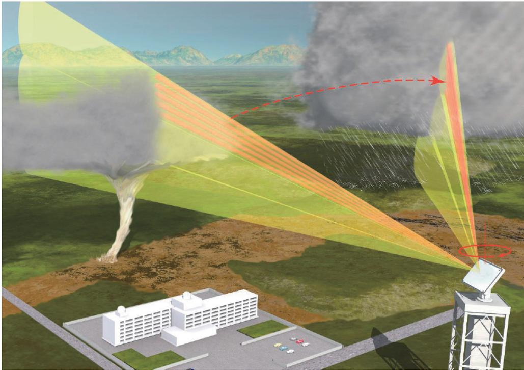
図2 フェーズドアレイレーダーによる観測（模式図）。
