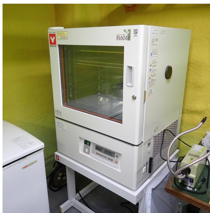
図5 温度設定可能な恒温箱（計測時は+8°Cに設定）。
