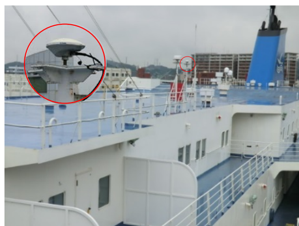
第3図:船舶に設置したGNSSアンテナの一例(関釜フェリー株式会社の「はまゆう」)。デッキ上部左舷側ポール(赤丸で囲んだ場所)に取り付け、下関と釜山を結ぶ航路上の可降水量を解析した。
