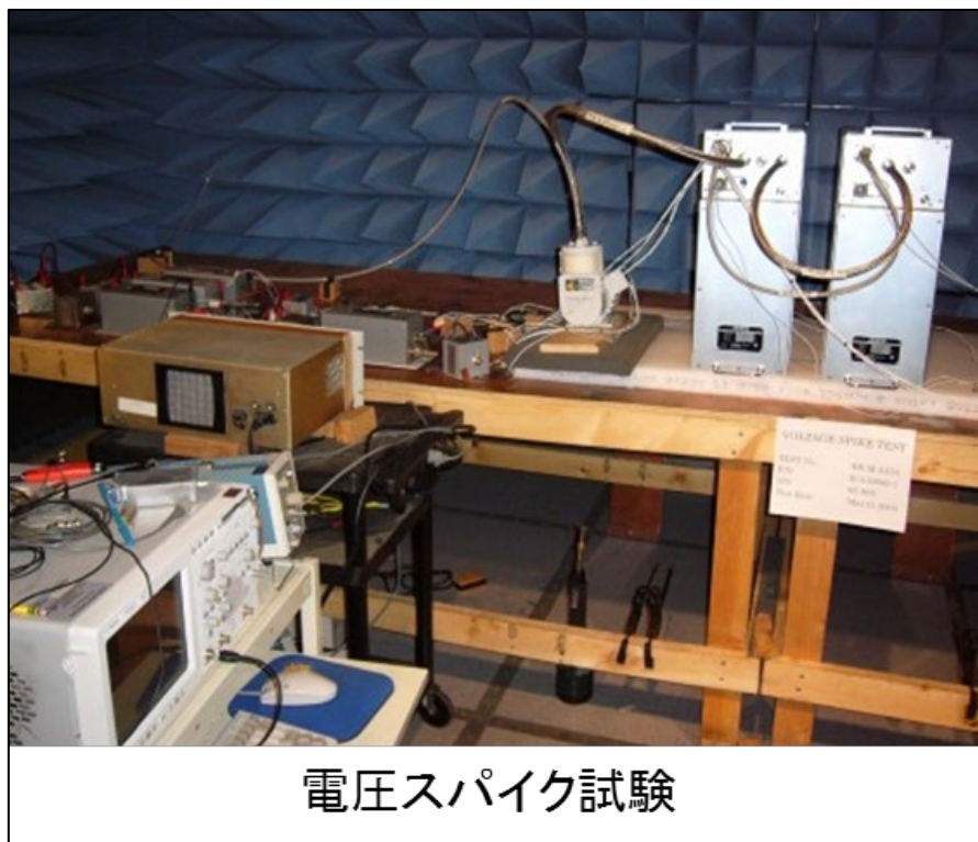
図 20 電圧スパイク試験。
