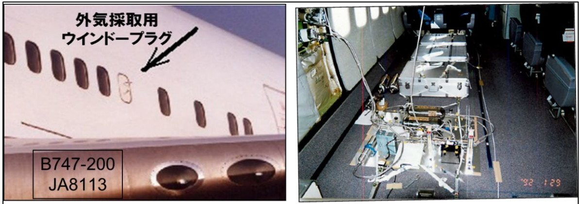
図 6 試験飛行の時のウィンドープラグ（左の写真）と機内でのサンプリング風景（右の写真）。
