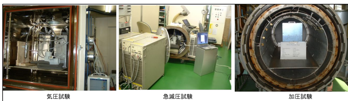
図 19 気圧、急減圧、加圧試験。
