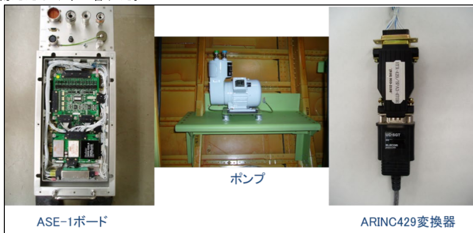
図 17 ASE の重要部品 (左から、ボード、ポンプ、ARINC429 変換器)。
