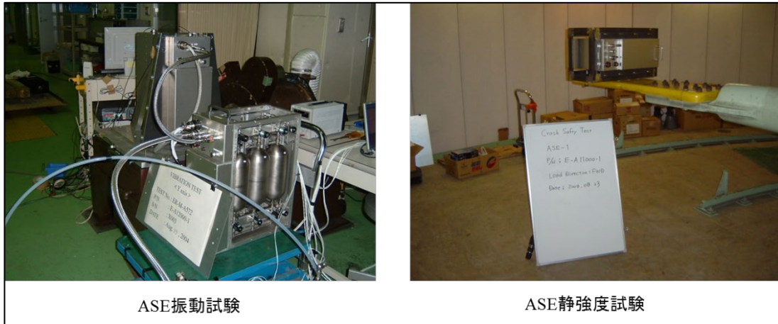
図 22 振動試験（左の写真）と静強度試験（右の写真）。
