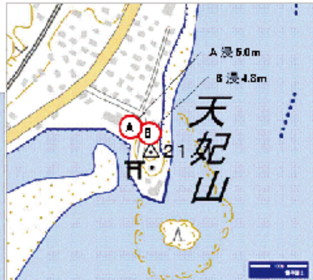
図 A4. 茨城県北茨城市磯原町磯原(地点番号 13)の現地調査測定点の位置および補正済みの津波高. (a)は位置図, (b)は詳細な位置と補正後の津波高. (b)の数値前の浸は浸水高であることを示す.
