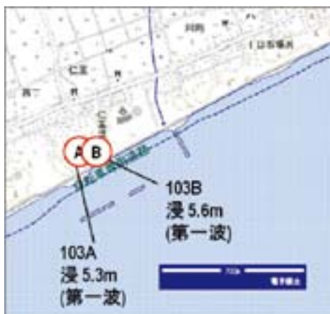
図 A8. 千葉県旭市西部の現地調査測定点の位置および補正後の津波高. (a)は地点番号 103 旭市中谷里, (b)は地点番号 109 旭市横根, および地点番号 110, 111, 102 旭市三川. 数値前の浸は浸水高, 遡は遡上高であることを示す. 第一波または第三波は最大波の出現時を示すが, カッコ付きで示したものは, その場所での証言が得られず, 推定による.
