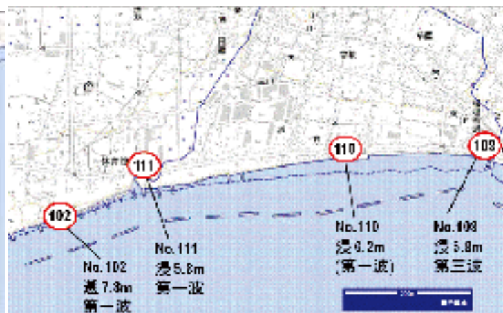
図 A8. 千葉県旭市西部の現地調査測定点の位置および補正後の津波高. (a)は地点番号 103 旭市中谷里, (b)は地点番号 109 旭市横根, および地点番号 110, 111, 102 旭市三川. 数値前の浸は浸水高, 遡は遡上高であることを示す. 第一波または第三波は最大波の出現時を示すが, カッコ付きで示したものは, その場所での証言が得られず, 推定による.
