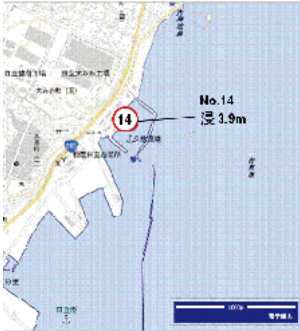
図 A5. (a) 茨城県日立市久慈町 1 丁目久慈漁港（地点番号 14）および (b) 茨城県ひたちなか市和田町那珂湊漁港（地点番号 4）の現地調査測定点の位置および補正後の津波高．数値前の浸は浸水高であることを示す．
