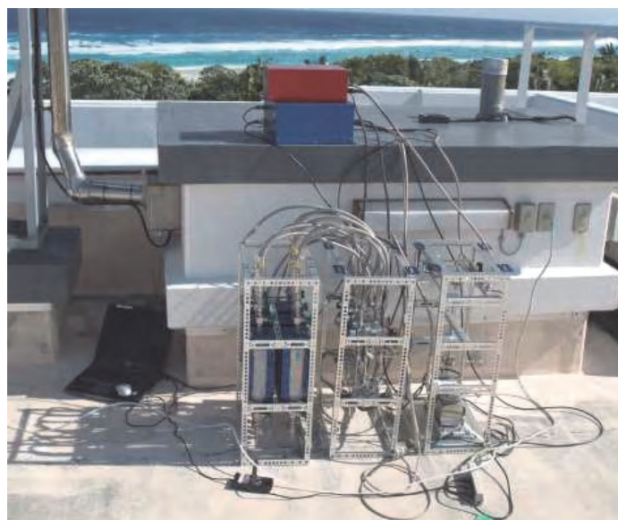
図 2-21 自動大気採取装置を設置した南鳥島気象観測所屋上での採取の様子。
