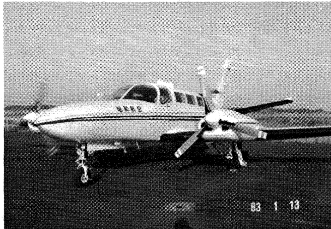
図 8.1 観測に使用したセスナ 404 型航空機 機体上面及び底面に日射計・赤外放射計が平行に取り付けてある。
