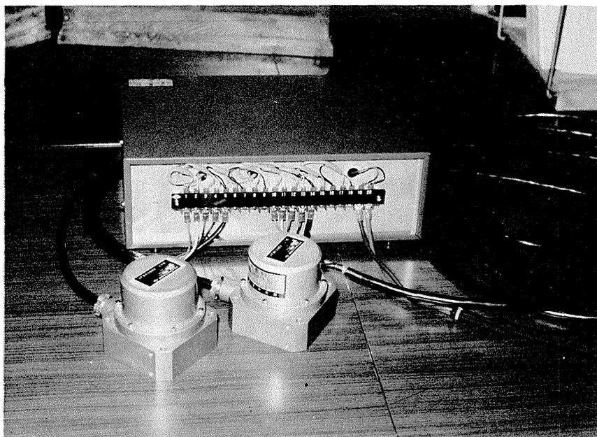
図 2.2.6 速度帰還方式の変換器の外観
