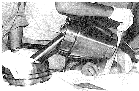
写真研7.1 二重首振りカップリングのジンバル部
