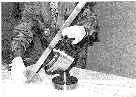
写真研7.2 従来型カップリングのジンバル部
