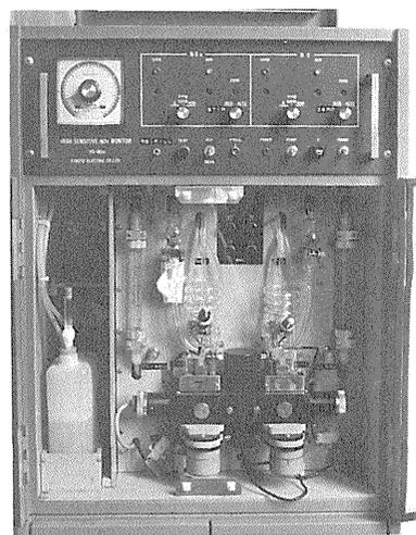
図 1.9 微量  $\text{NO}_x$  自動測定装置の内部写真
