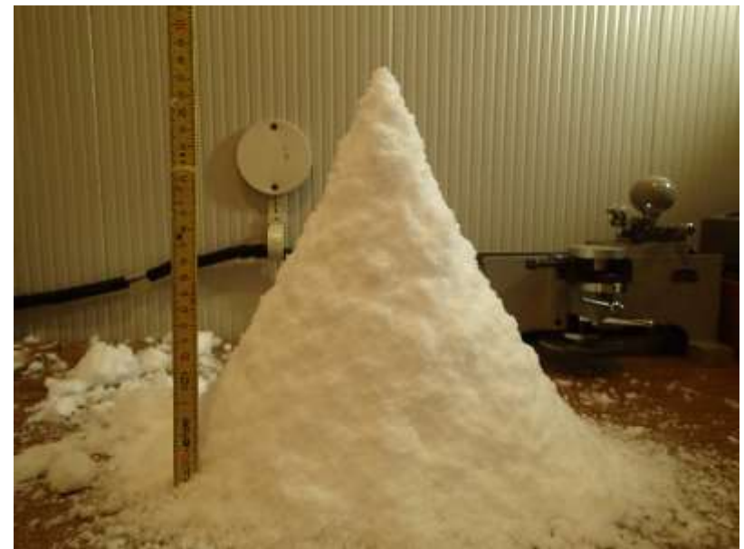
2015/2/10 冬型の気圧配置降雪 安息角 65^{\circ} （＃4mmのふるい・ -5^{\circ}\text{C} 低温室）
