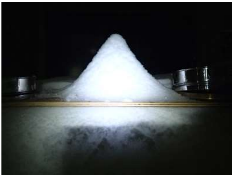
2015/1/30 低気圧通過時降雪 安息角 53^{\circ} （＃4mmのふるい・ -2.6^{\circ}\text{C} 屋外）
