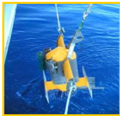
図2 啓風丸に搭載されている曳航式CTD
